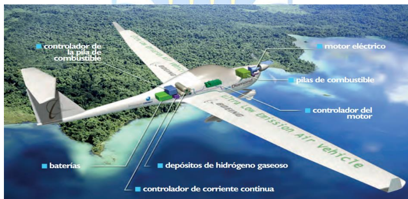
Figura 8 Avioneta eléctrica con pilas de combustible de hidrógeno
