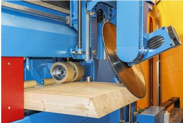
*Fig. 7 Unidad de mecanizado de 5 ejes y rodillos de alimentación.*
