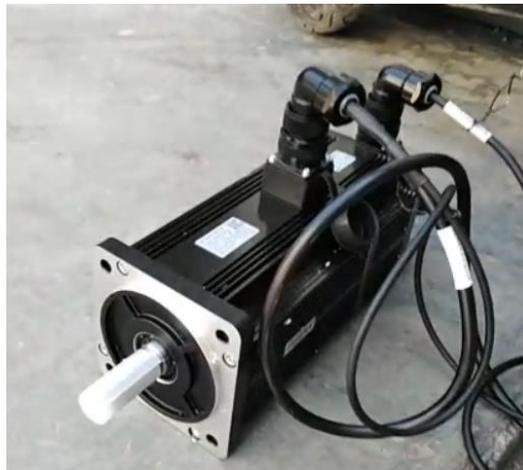
Fig. 80 Servomotor 15[Nm] con freno magnético.
