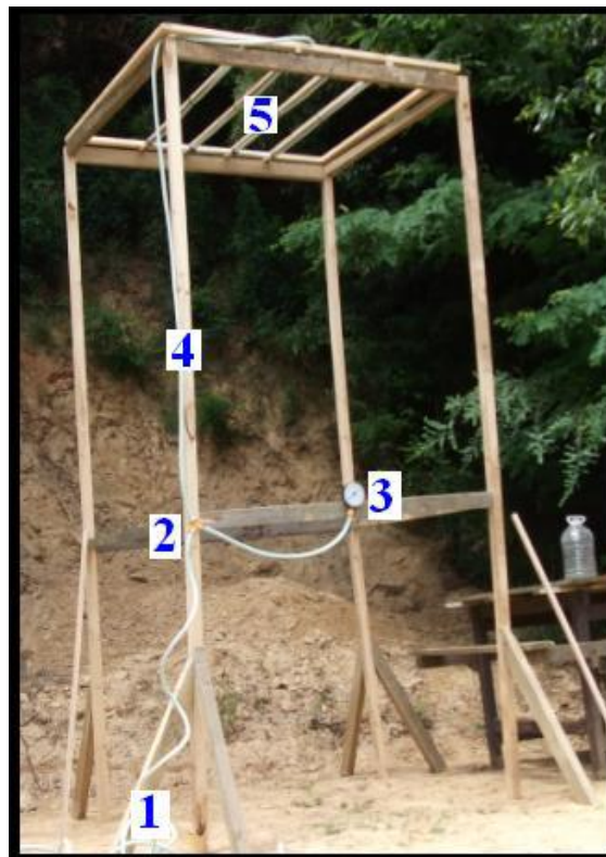
Figura 3: Simulador de lluvia. 1) Manguera de alimentación; 2) Bifurcación; 3) Manómetro; 4) Estructura soportante; 5) Sistema de aspersión
