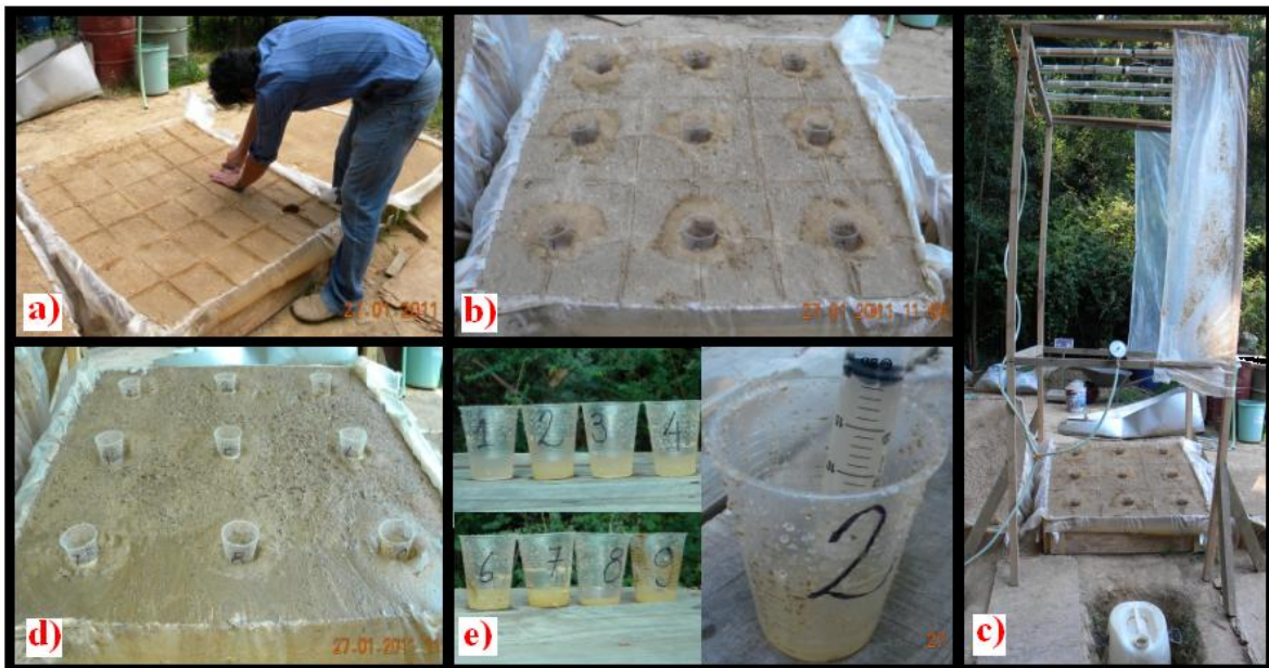
Figura 14: Calibración: a) Trazado de grilla y excavación para apoyo de vasos, b) Colocación de vasos de acuerdo serie 1-2-3 (superior), 4-5-6 (medio) y 7-8-9 (inferior), c) Aplicación de la lluvia, d) Recolección del volumen precipitado, e) Medición del volumen almacenado.
