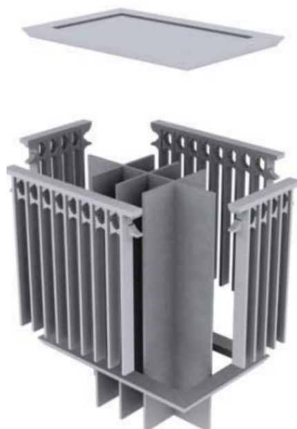
Figura 2.12: Modelo 3D de una torre de viento con canales iguales (fuente: Zarandi, 2009)
