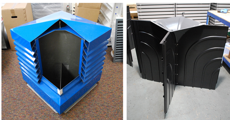
Figura 2.14: : Windcatcher™ cuadrado, de la firma Monodraught. En la imagen de la izquierda se aprecian las celosías exteriores mientras que a la derecha se pueden apreciar los divisores internos que fraccionan el sistema de ingreso y egreso de aire en cuatro cuadrantes.
