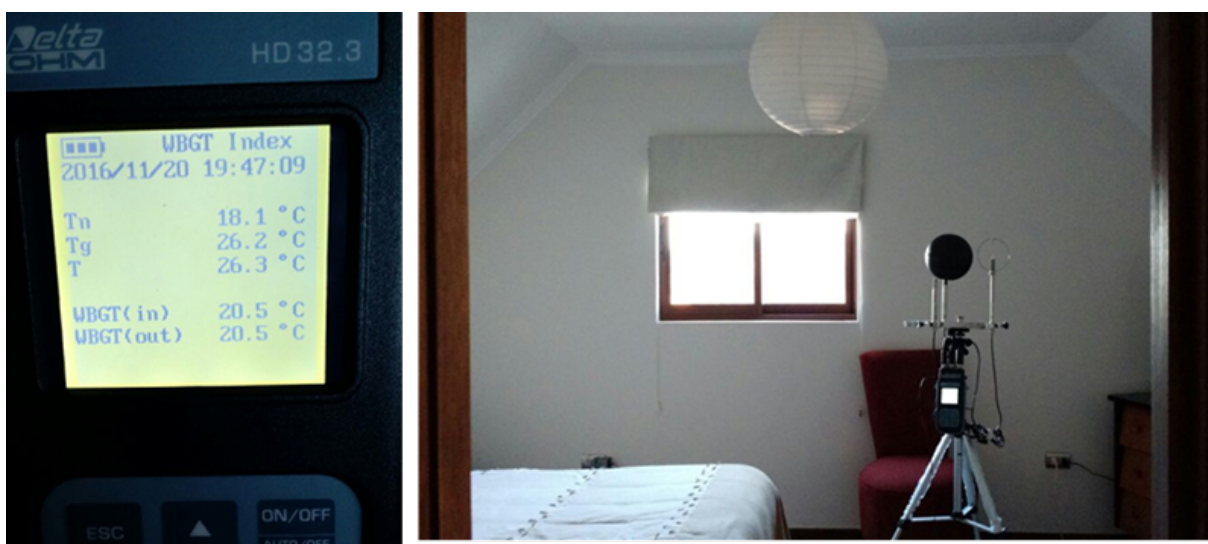
Figura 4.9: Registro de temperaturas interiores del ático, a través de un medidor de estrés térmico HD32.3 WBGT.
