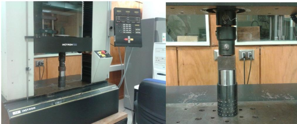
**Figura 4.22 Determinación Experimental de la presión de extrusión para el cuesco de ciruelo Europeo.**
