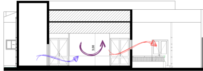
Figura 37: Esquema de ventilación en corte
