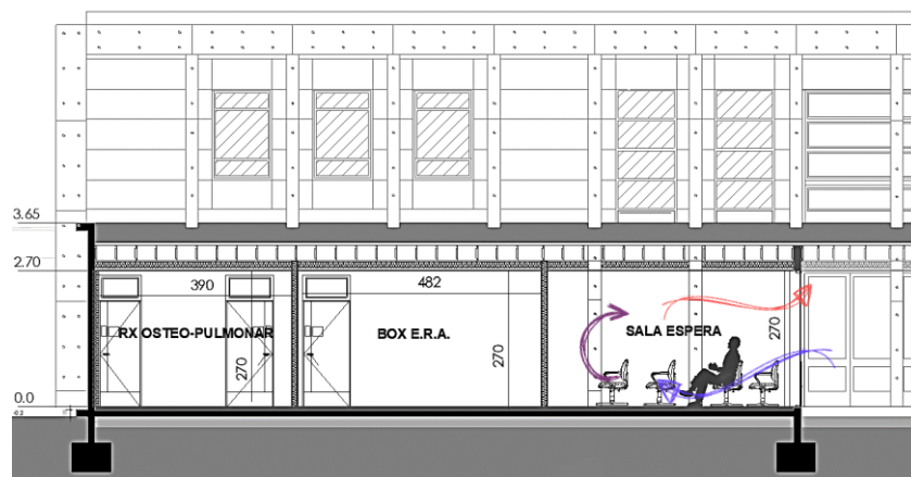
Figura 28: Esquema en corte de ventilación natural
