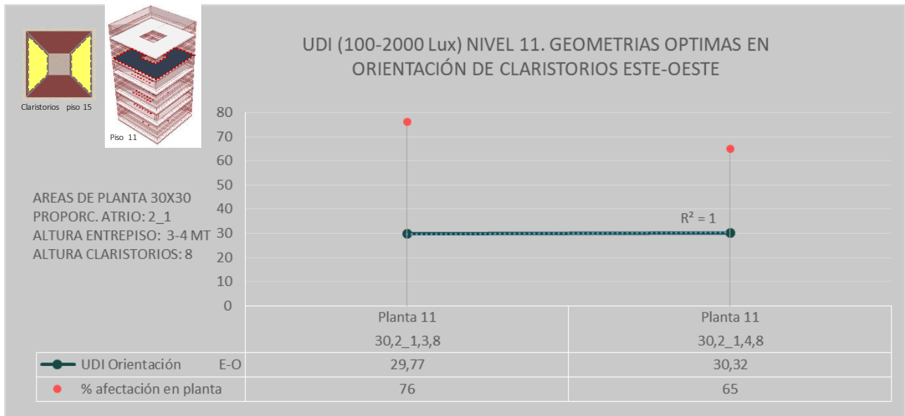
Gráfica 17. Clasificación de Geometrías óptimas para orientación de Claristorios Este-Oeste. Planta 30x30 mt2. Nivel 11
