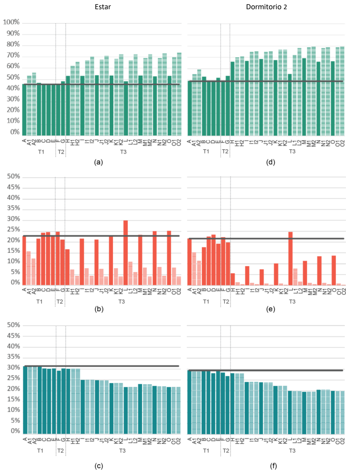
Figura 4-12. Porcentaje de tiempo en confort o desconfort por caso de estudio en relación al caso base, Escenario clima actual, Estar: (a) Tiempo total en confort (b) Tiempo en desconfort por calor (c) Tiempo en desconfort por frío, Dormitorio 2: (d) Tiempo total en confort (e) Tiempo en desconfort por calor (f) Tiempo en desconfort por frío.
