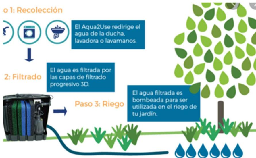
Figura 22. Sistema de reciclaje de aguas.(Fuente:
