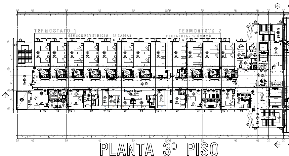
Figura 3.26. Planta de arquitectura Edificio C, 3er piso de hospitalización con ubicación de termostatos.
