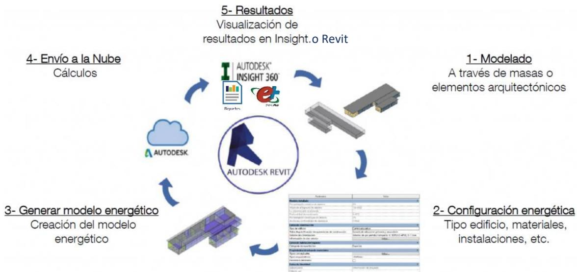
Figura 4 Flujo de trabajo análisis energético en Revit Insight 360
