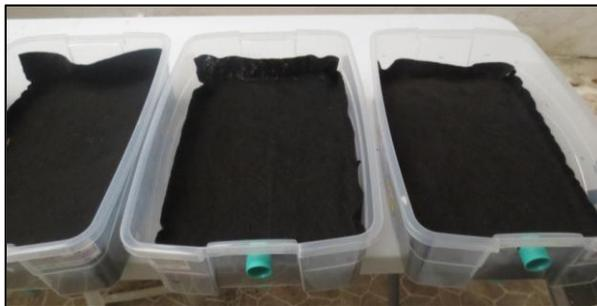
Figura 3.2: Instalación del Geotextil NT 1500 sobre capa de drenaje de GCR.
