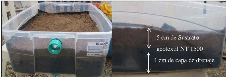
**Figura 3.9: Construcción de probetas**
