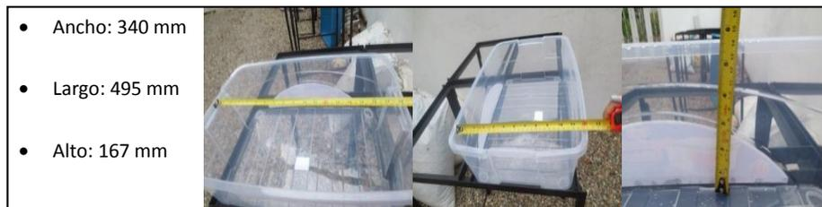
**Figura 3.5: Dimensiones de los recipientes usados para la construcción de las probetas**
