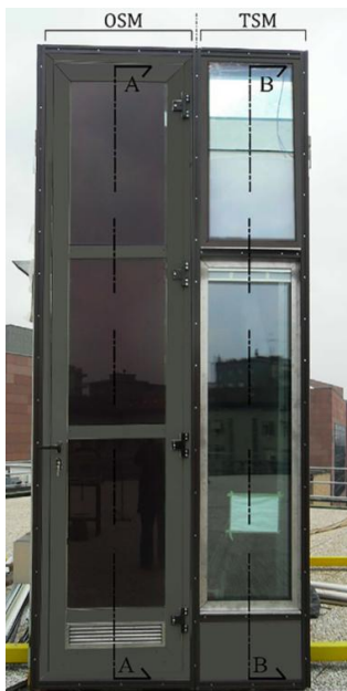
Figura 3.- Módulos OSM y TSM de la fachada tipo MFM llamada ACTRESS. Foto obtenida de [20].-
