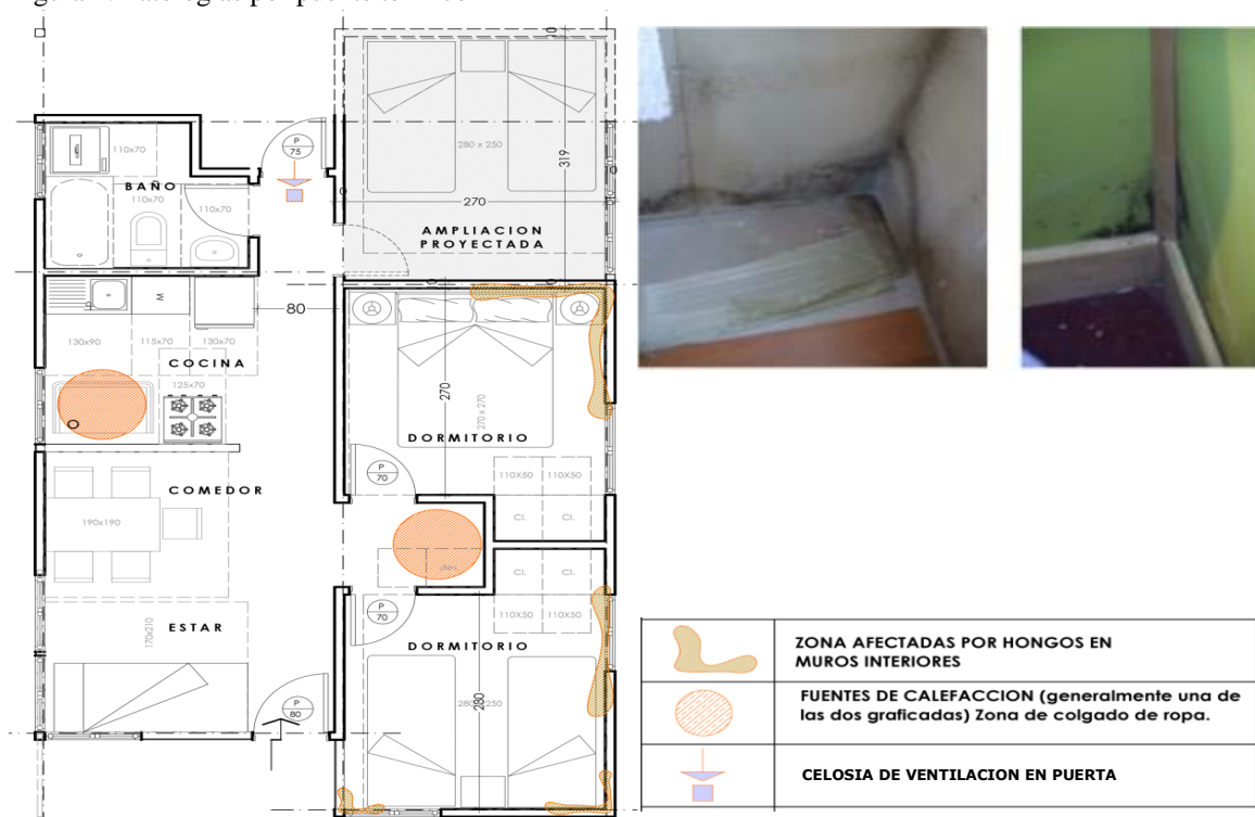
Figura 4: Patologías por puente térmico
