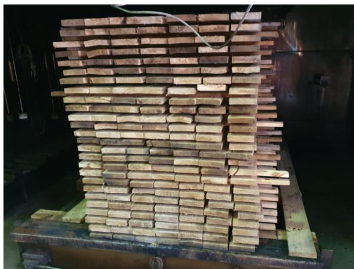
Figura 28 Carga de madera seca por radiofrecuencia y vacío en el secador flexible (Fuente: elaboración propia)
