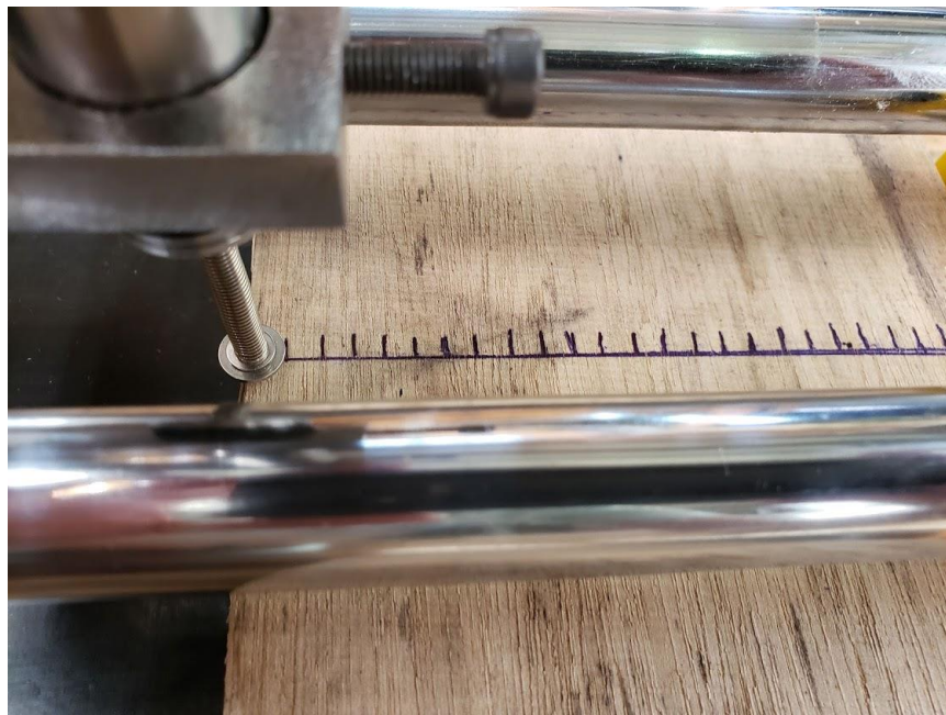
Figura 15 Medición de colapso a una pieza testigo a través del sensor LVDT (Fuente: elaboración propia)
