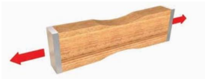
Figura 8 Esquema de ensayo de tracción paralela a las fibras (Fuente: Corma 2008)
