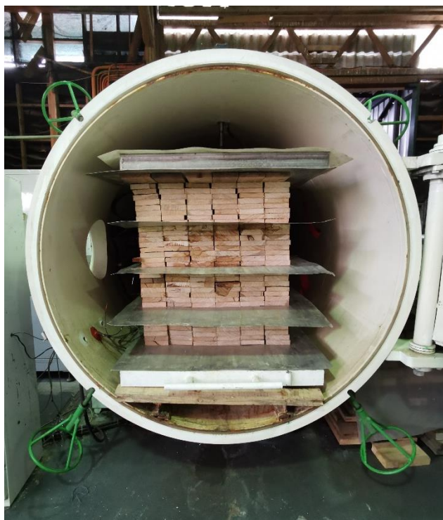
Figura 22 Carga de madera en el equipo de radiofrecuencia y vacío (Fuente: Elaboración propia)
