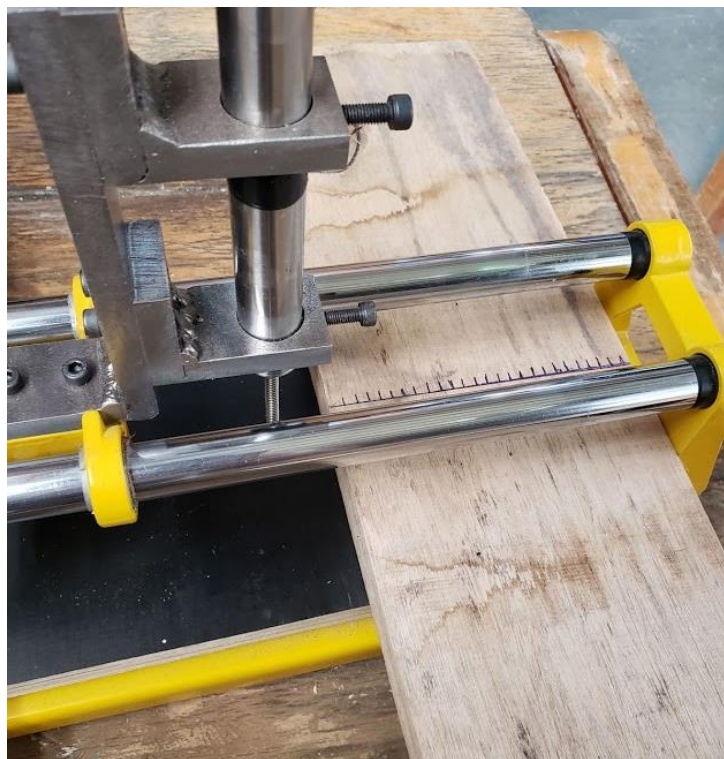
Figura 26 Medición del colapso en una pieza testigo (Fuente: elaboración propia)
