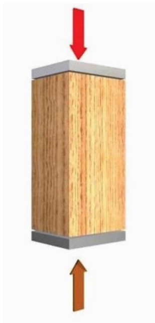
Figura 5 Esquema de ensayo de compresión paralela a las fibras (Fuente: Corma 2008)
