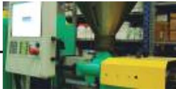
Se introduce en la maquina de inyección que calienta el plástico hasta 140°C para que llegue a su punto de fusión
