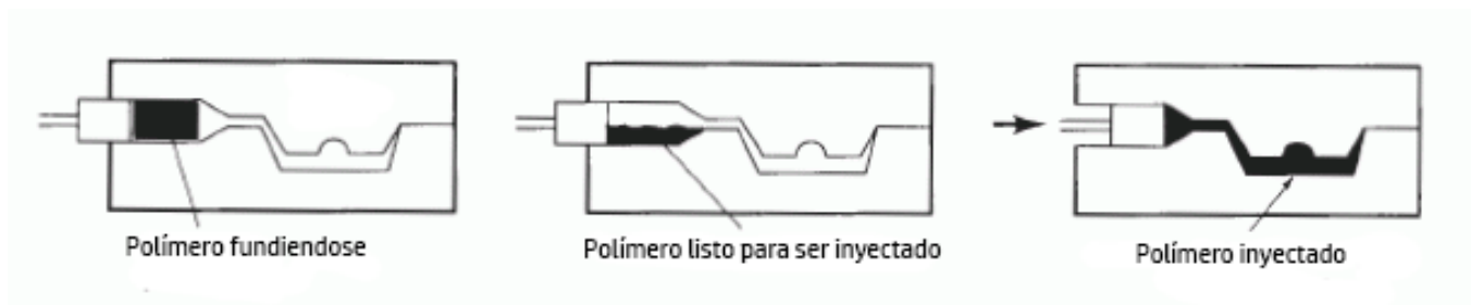
Figura 31. Esquema de moldeo por transferencia. (2018) fadiplast.com
