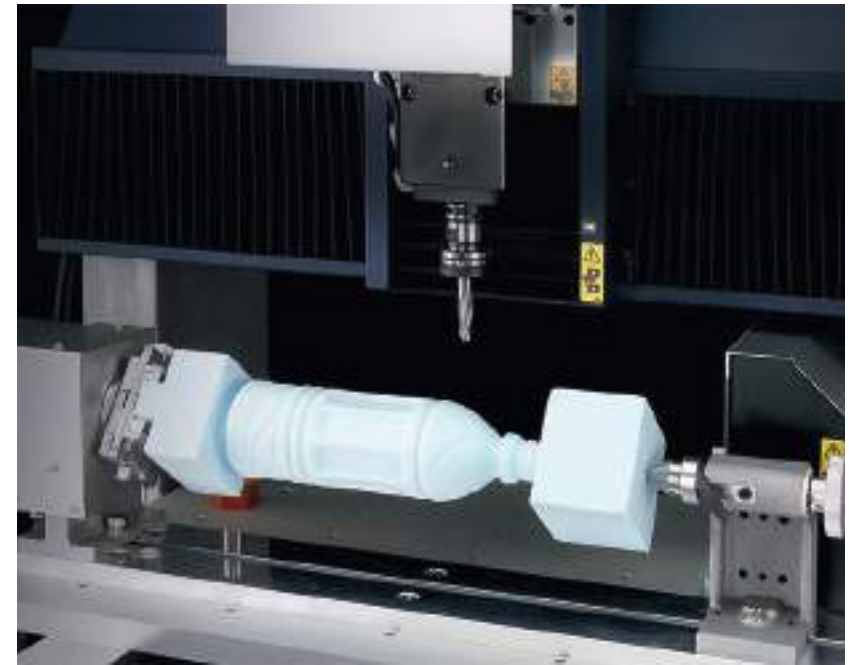
Figura 12. proceso de mecanizado por CNC en plástico. Fuente: www.rolanddgi.com
