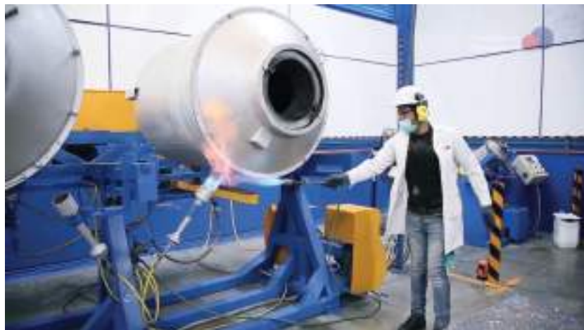
Figura 27, Fabricación de pieza en rotomoldeo con flama abierta. Fuente: Polímeros mexicanos.
