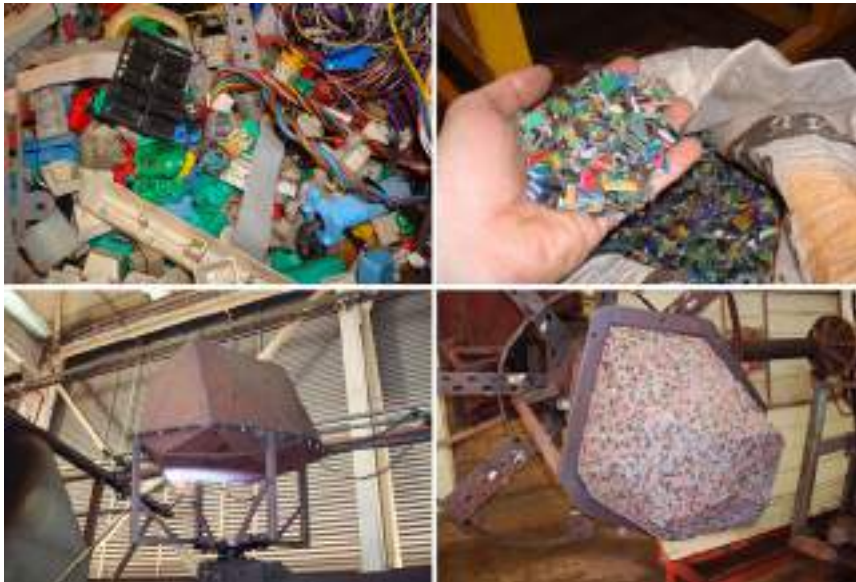
Imagen 54. Pieza realizada en Chile, a partir de Polipropileno reciclado, proceso productivo; Rotomoldeo.
