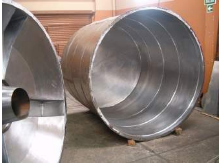
Imagen 51. Matrices realizadas a partir de Acero inoxidable.
