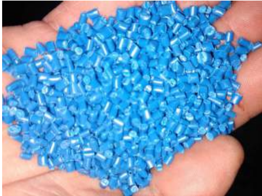
Imagen 55. Pellet de Polietileno (PE), para rotomoldeo.
