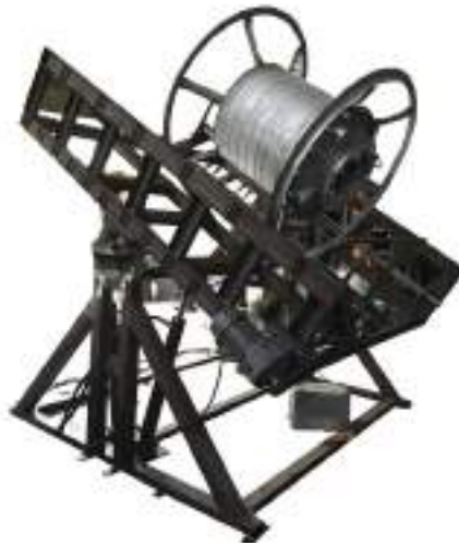
Imagen 73. Equipo de Rotomoldeo de Giro o Rock and Roll
