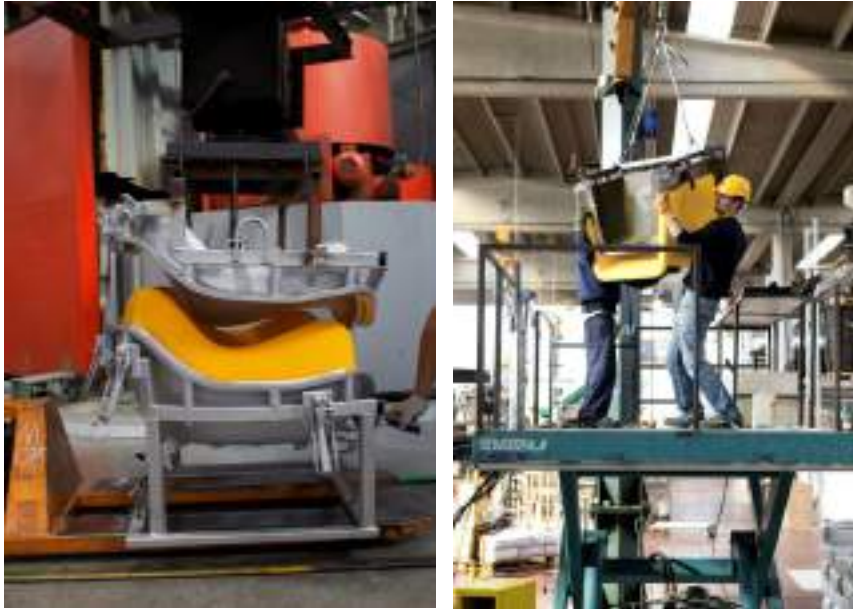
Imagen 49. Matrices en Proceso de Rotomoldeo o Moldeo Rotacional.
