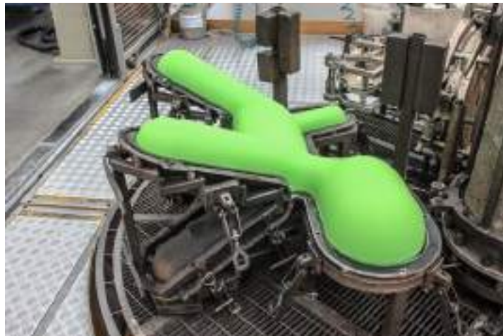
Imagen 52. Matrices realizadas a partir de Aluminio.
