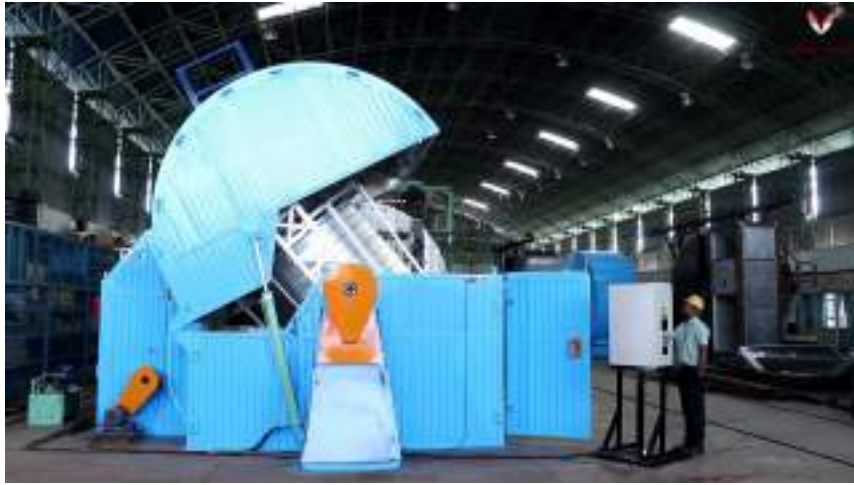
Imagen. 72 Equipo de Rotomoldeo Clamshell
