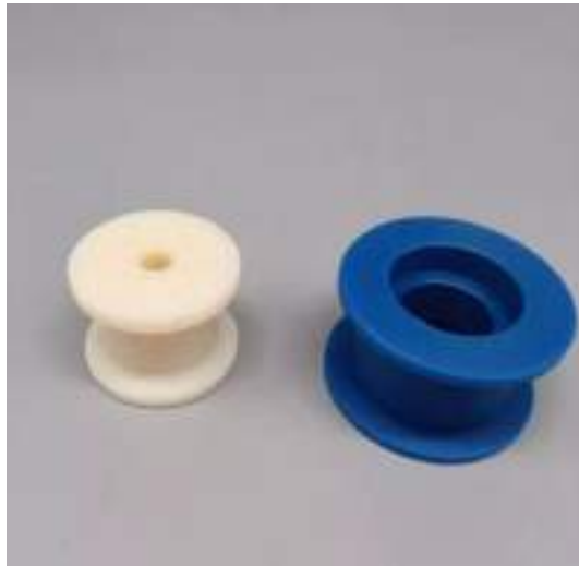
Imagen 76. Piezas de Technyl modeladas por inyección.
