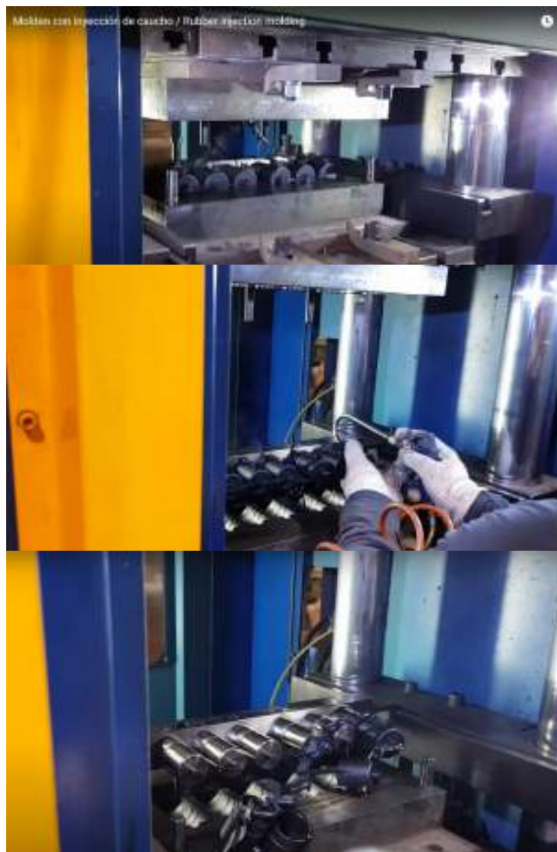
Imagen 82. Proceso moldeo por inyección: Tapones caucho sintético.
