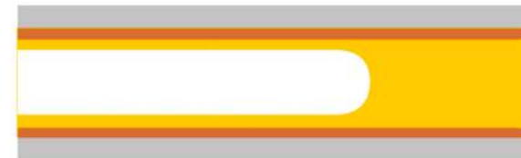
INYECCIÓN DE GAS
