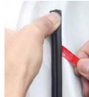
Figura 74 Fotografía 33: Pegado de sección de goma Fuente: https://www.amazon.co.uk/HG-Adhesive-Automotive-Anti-dust-Weatherstrip/dp/B07KF9ZZFG
