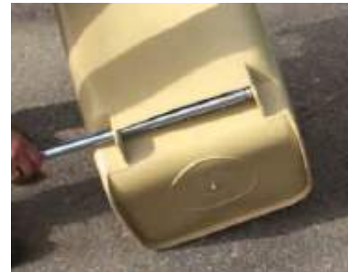
Figura 87 Fotografía 40: Instalación de eje de ruedas Fuente: https://www.youtube.com/watch?v=4t4AhC1UCDo (2015)
