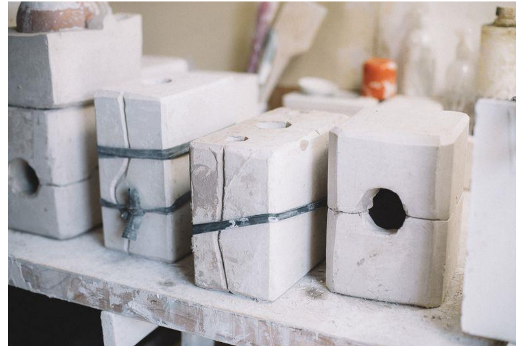
Figura 73: Moldes de yeso amarrados con cámaras de bicicleta. Recuperado de https://www.latercera.com/paula/camila-carrasco-disenadora-industrial-ceramista/
