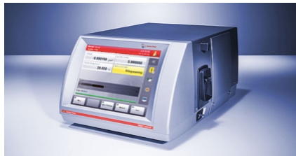
Figura 11. Densímetro Anton Paar DMA 5000. Fuente: Manual de usuario densímetro Anton Paar DMA 500.
