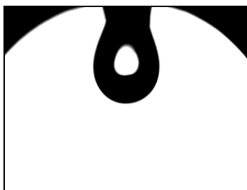
Figura 13. Medición de tensión superficial de Emim Cl a 363,15 K y 1 Atm de Ar, mediante método de gota suspendida. Fuente: Elaboración propia.
