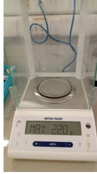
Figura 10. Balanza analítica Mettler Toledo-ML204. Fuente: Elaboracion propia.
