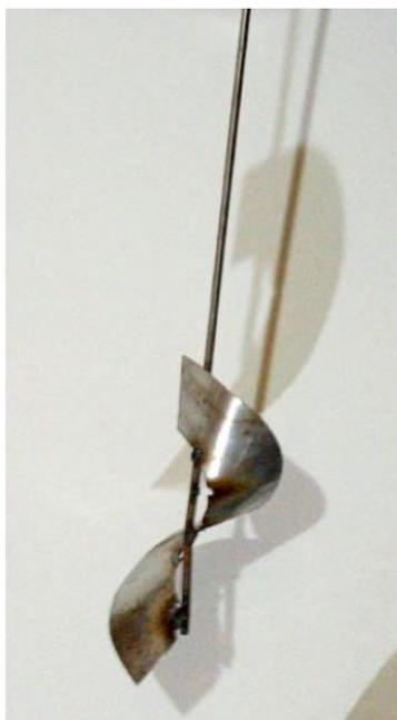
Figura 13. Agitador tipo helicoidal de acero inoxidable.
