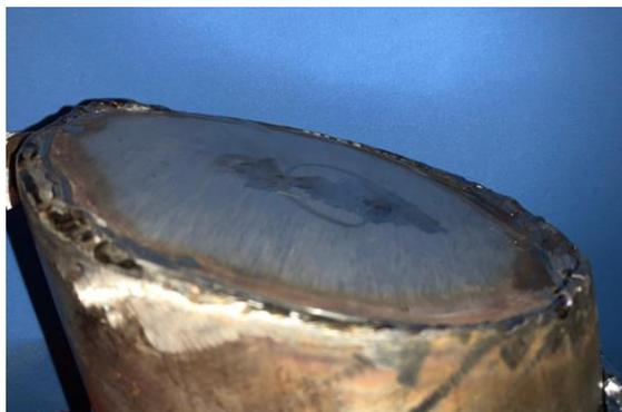
Figura 9. Fondo de acero inoxidable soldado a tanque digestor.
