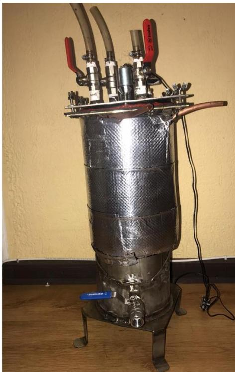
Figura 15. Pared externa de tanque digestor con aislante recubierto.
