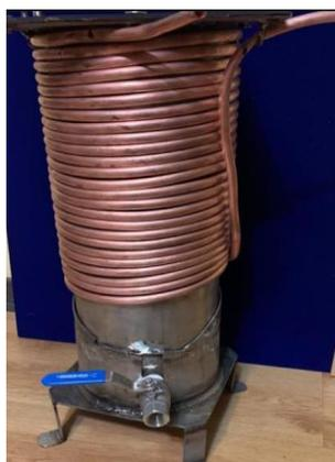
Figura 14. Tanque digester con serpentín externo de calefacción instalado.
