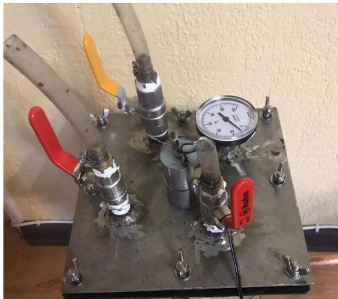
Figura 11. Tapa superior con válvulas y sensor de temperatura incorporado.
