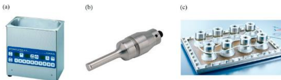
Figura 9. Diferentes tipos de generadores de ultrasonidos: (a) baño ultrasónico, (b) bocina ultrasónica y (c) transductor de placa ultrasónica. Obtenido de Kim y Suslick (2018).
