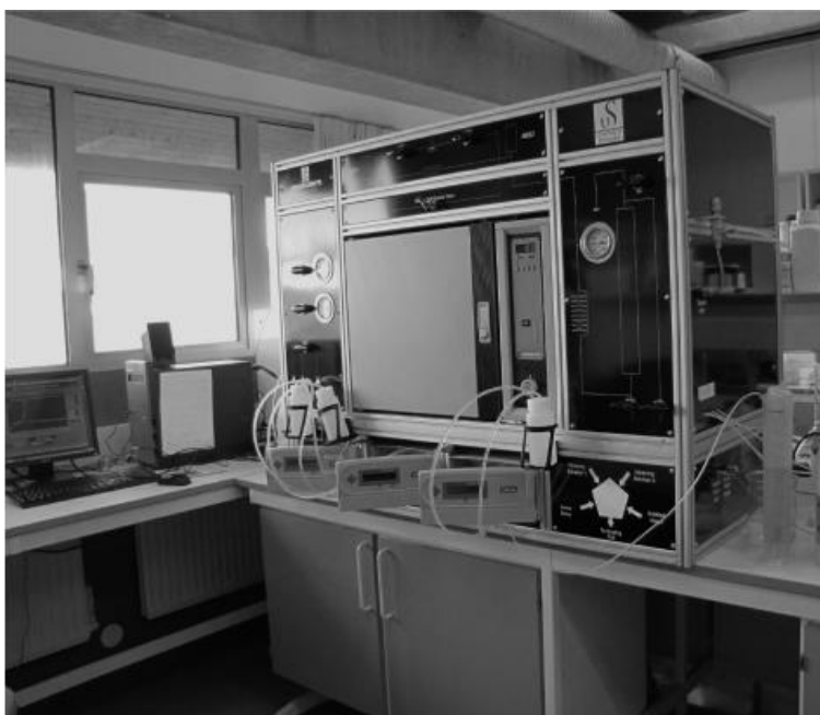
Figura 11. Equipo para la prueba de bloqueo dinámico de tubos de los inhibidores de incrustaciones. Obtenida de Kelland (2011).
