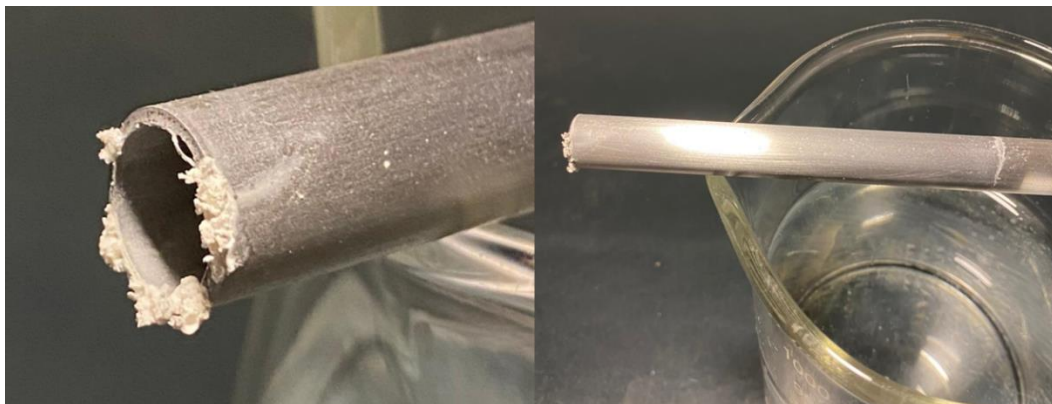
Figura C1. Incrustaciones de sulfato de calcio ( \text{CaSO}_4 )
