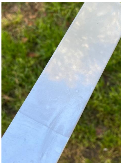
Figura C2. Incrustaciones de carbonato de calcio ( \text{CaCO}_3 ).
