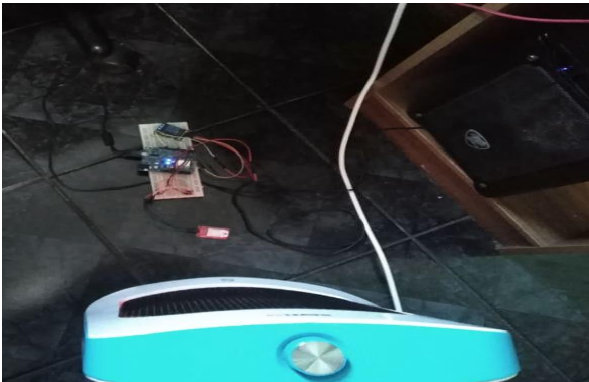
Ilustración 15. Prueba 2 sensor temperatura (Cerca de fuente de calor).
