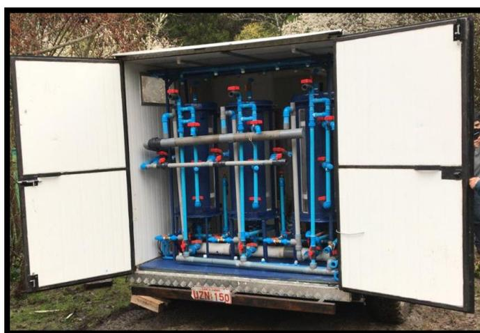
Figura 10. Sistema de fotobiorreactores montado en el vehículo de transporte.
