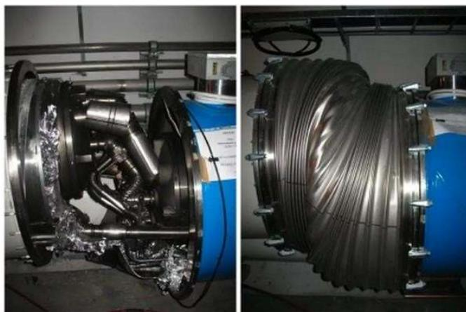
Figura 5: la imagen muestra dos de las interconexiones más severamente rotas, que se encuentran entre los imanes en los sectores LHC tres y cuatro. Los imanes superconductores, utilizados para dirigir y enfocar los haces de protones en el experimento, se enfrían con helio líquido [10].
