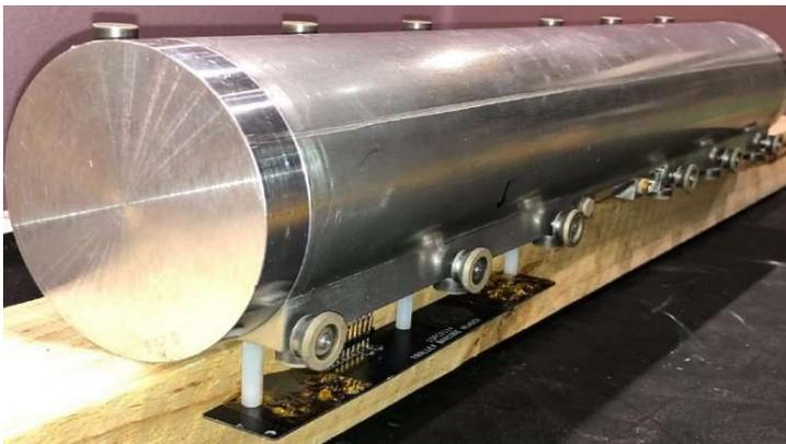
Figura 29: Sistema de carro ensamblado con ruedas, con carcasa cilíndrica de 50 cm de largo, incluyendo 17 sondas RMN [45].
