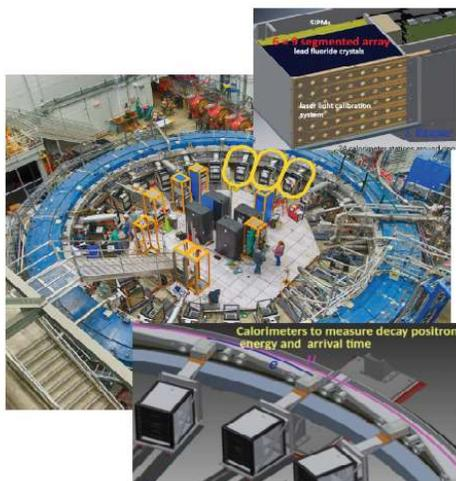
Figura 34: Calorímetros en el anillo de almacenamiento de muones [43].
