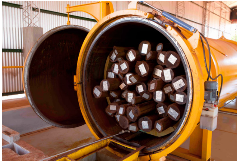
Figura 1. Cámara de impregnado industrial por método de vacío-presión (INFOR, 2015).
