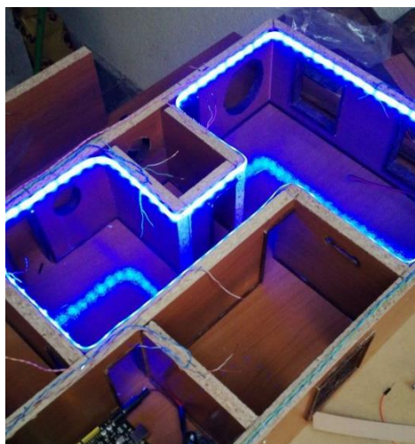
Fig. 7.7. Tira de Leds en funcionamiento
