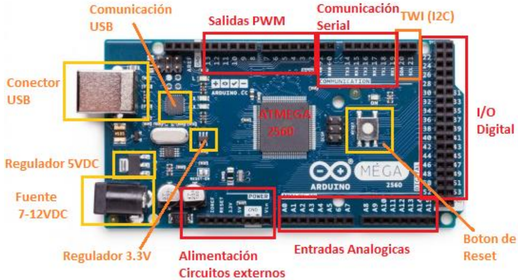
Fig. 3.2. Elementos de la tarjeta Arduino Mega 2560.
