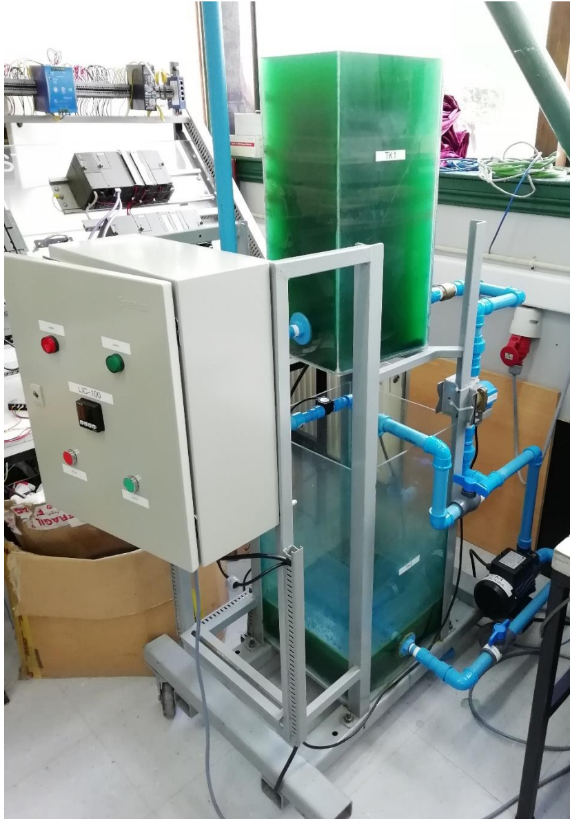
Figura N°60: Maqueta de control de nivel
