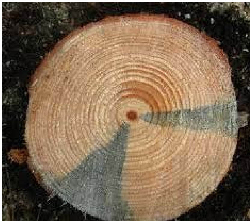
Figura 7. Rollizo Afectado por el Hongo de la Mancha Azul
