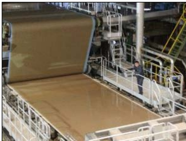
Figura 249. Mesas formadoras fourdrinier de líneas Back y Top de máquina papelera FPC Papeles.
