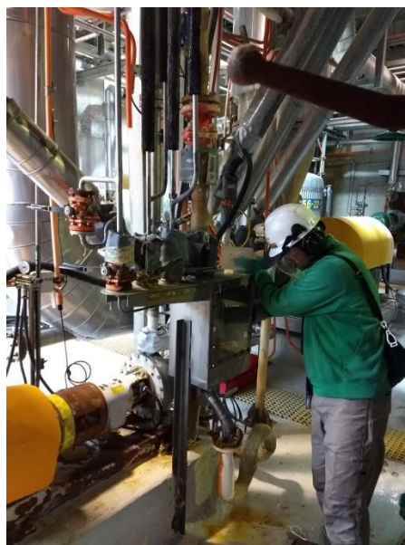
Imagen 2. Toma de muestra salida torre de absorción y salida TK almacenamiento de dióxido de cloro.
