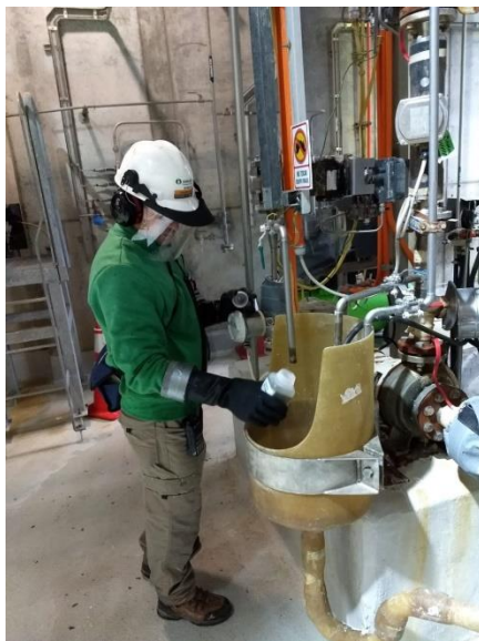
Imagen 1. Toma de muestra en descarga de TK disolvedor.
