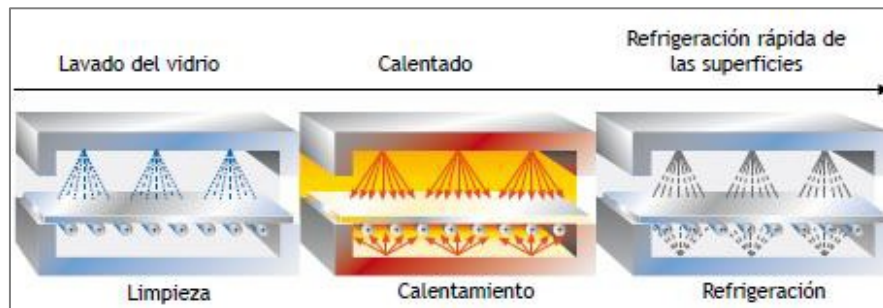
Figura 1. Fabricación de VSM Y VST Kuraray Europe. (2013). Technical Manual del film PVB Trosifol.
