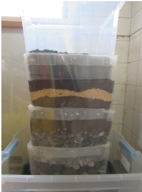
Figura 7: Propuesta sistema de lombrifiltro a escala de laboratorio
