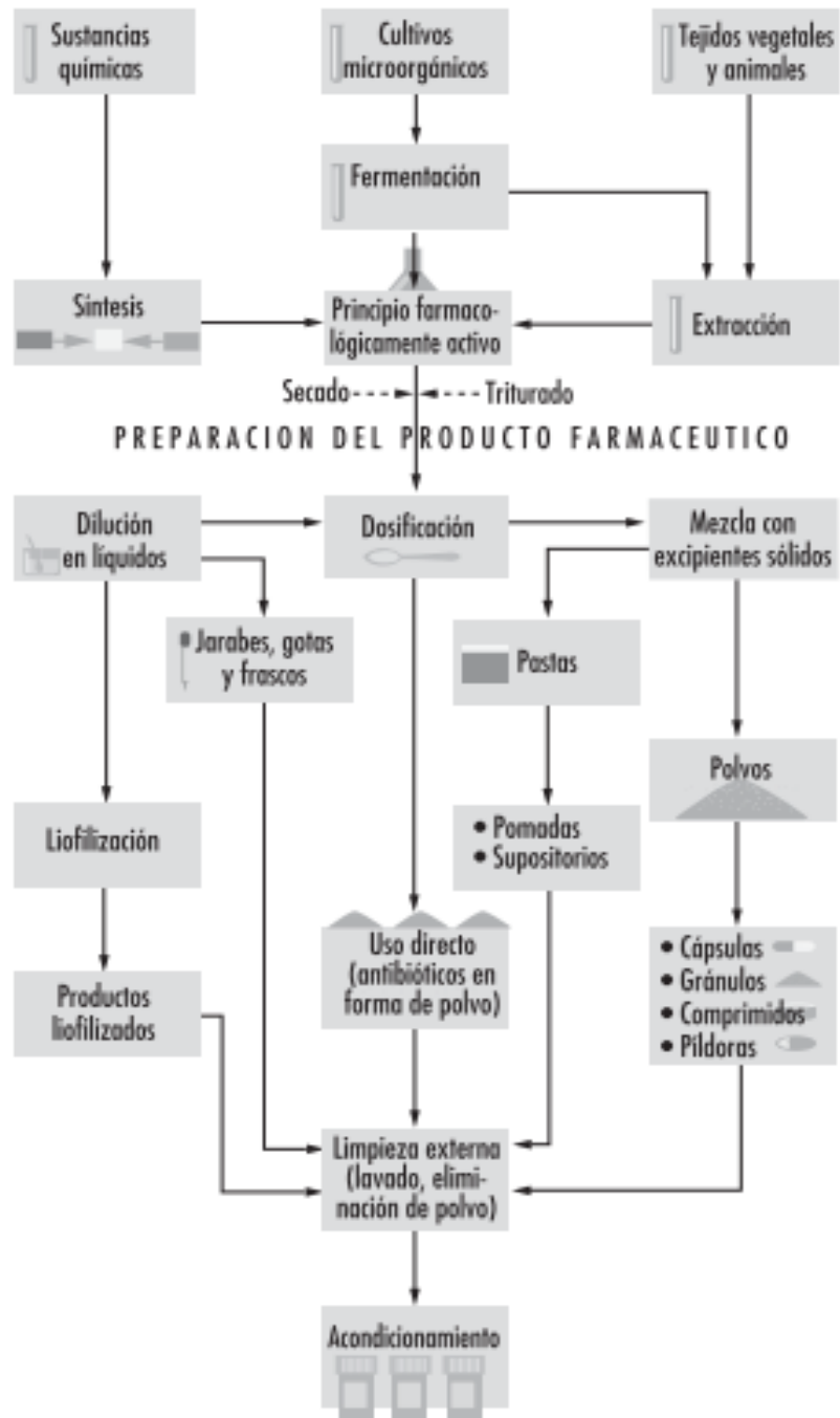
Figura 24. Diagrama de Bloque de las fabricaciones realizadas en toda industria farmacéutica. (Fuente: Tait, 2012).
