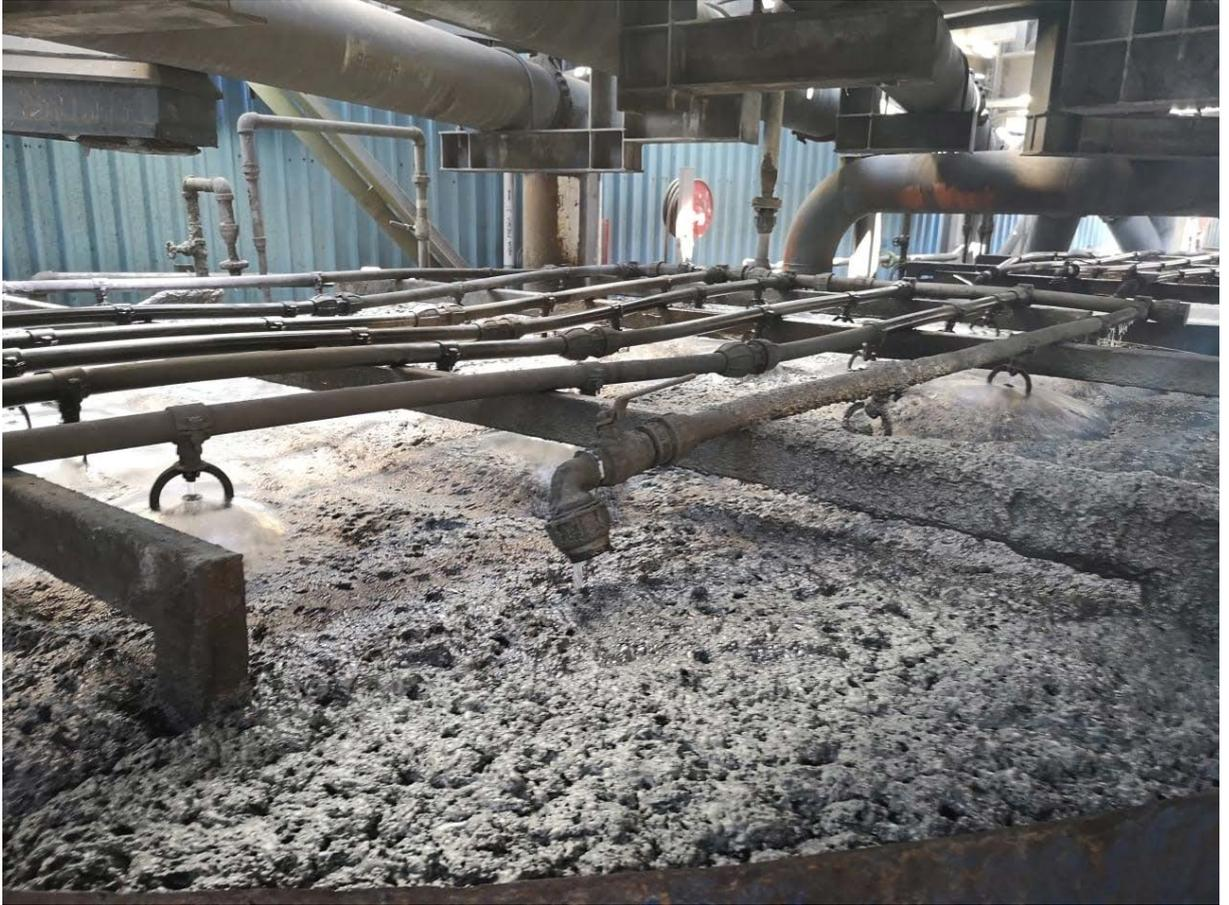
*Figura 47. Flotación columnar y aspersores en funcionamiento.*
