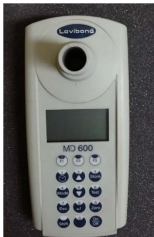
Figura 12. Espectrofotómetro, dispositivos para analizar reactivos de DQO.
