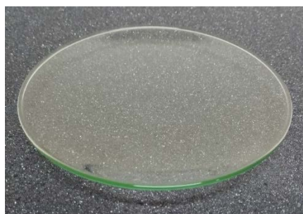
Figura 14. Vidrio Reloj, posa filtro de fibra de vidrio.
