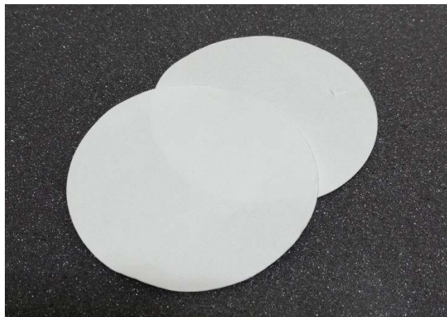
Figura 13. Filtros de fibra de vidrio para realizar filtración de SST.
