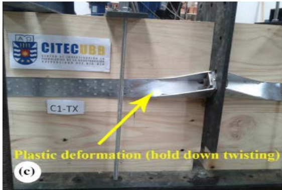
Figura 7: Ensayo Conectores Metálicos (Benedetti et al. 2019)
