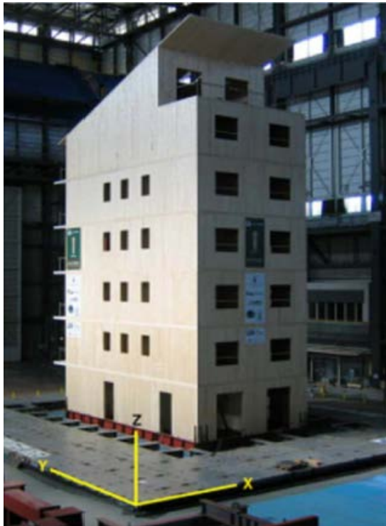
Figura 20: Estructura 7 pisos Sofie Project (Ceccotti et al. 2013)
