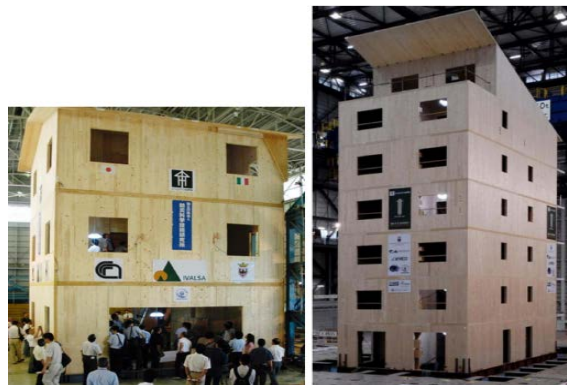
Figura 8: Ensayos sísmicos a escala real (Ceccotti et al. 2016)
