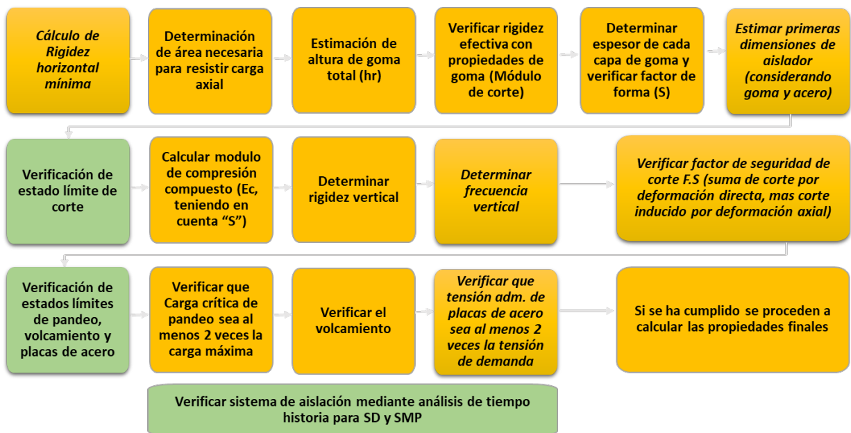
Figura 19: Proceso de diseño de HDR (Elaboración propia)
