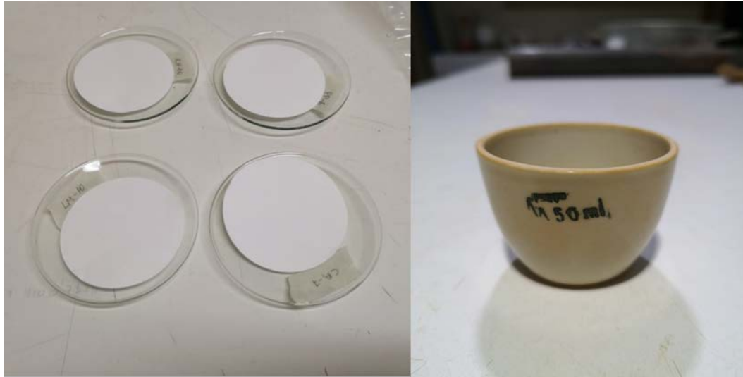
Figura 17: A la izquierda capsulas usadas para secado de muestras en horno a 105°C, a la derecha un crisol utilizado en la volatilización del material. (Elaboración propia).
