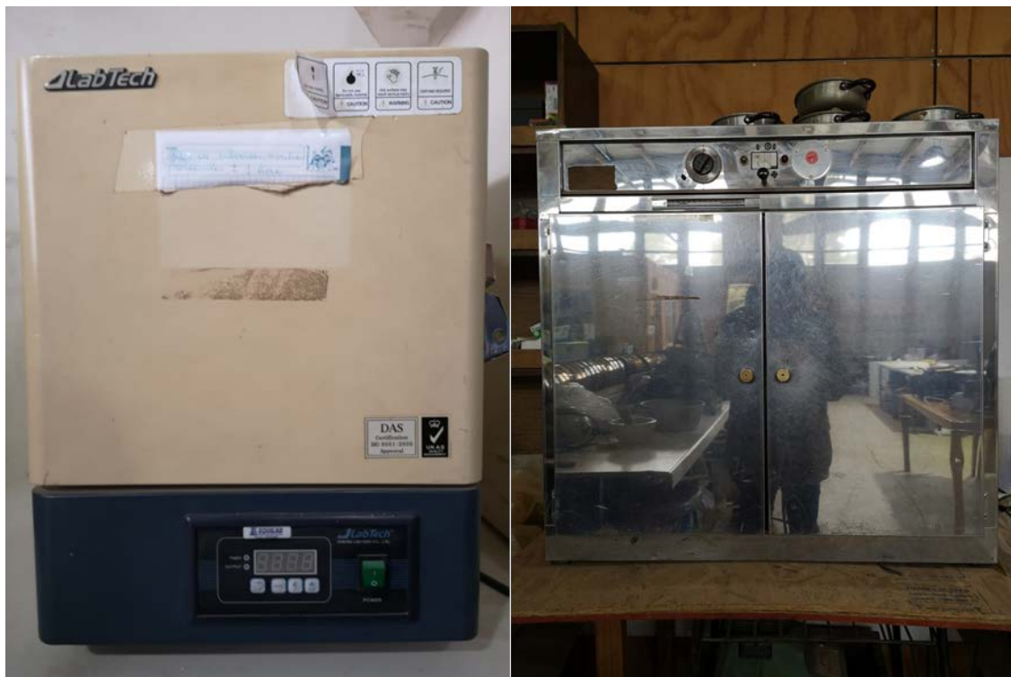
Figura 16: Equipo usado para el secado de muestras, a la derecha el horno mufla para ignición y a la izquierda un horno desecador con sistema de ventilación. (Elaboración propia)
