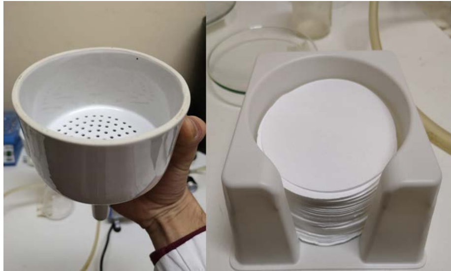
Figura 13: Equipo utilizado para el filtrado de la muestra, a la izquierda podemos ver un embudo Buchner y a la derecha encontramos los filtros de fibra de vidrio. (Elaboración propia).
