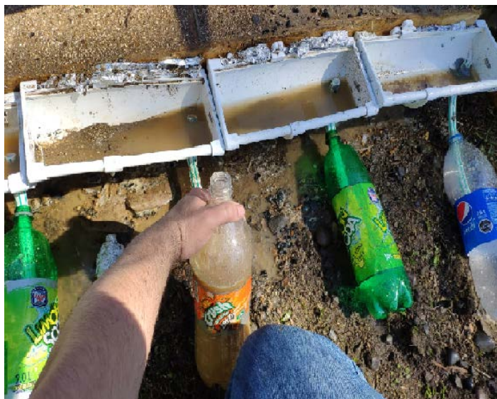
Figura 18. Recepción de material erodado y escorrentía superficial
