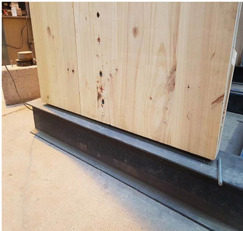
Figura C8: Estado Ultimo en Levantamiento del Ensayo N°2.
