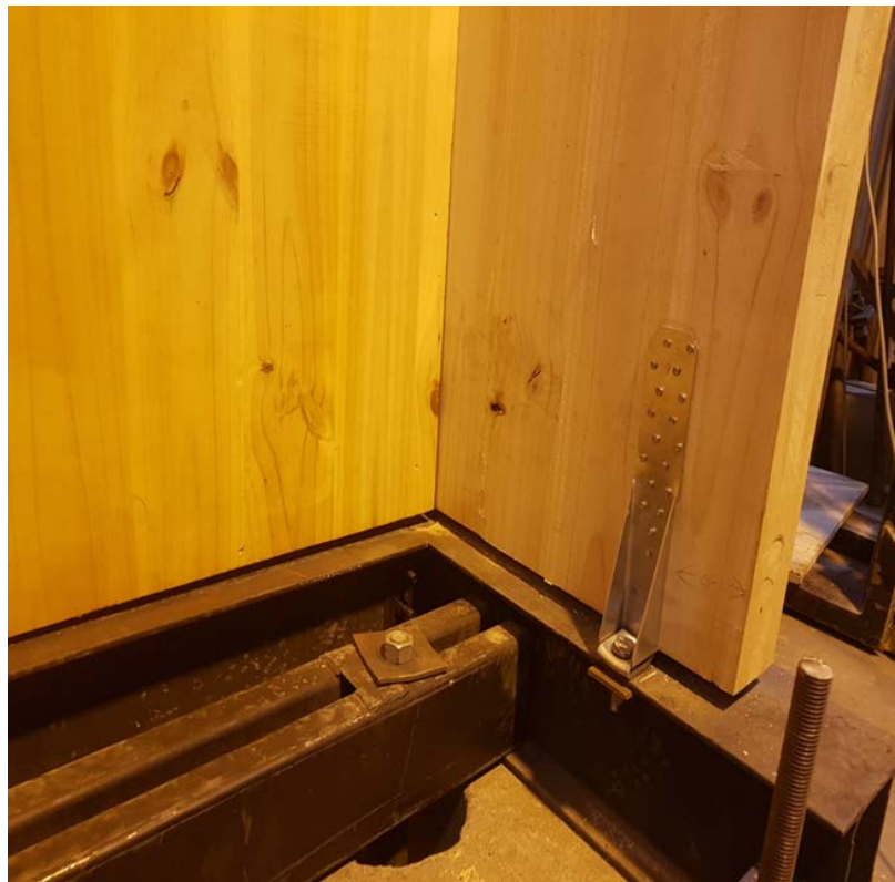
Figura C6: Estado Ultimo en Levantamiento del Ensayo N°1.
