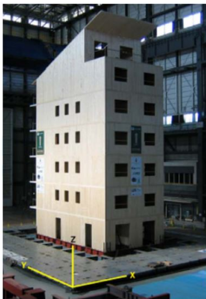
Figura 7: Edificio de 7 pisos en mesa vibratoria (Ceccotti et al., 2013).
