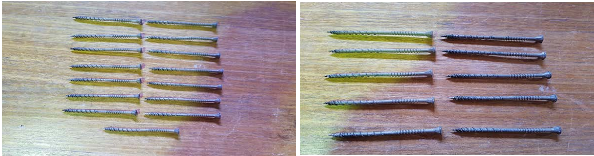
Figura C11: Tornillo DSVT3R al final del Ensayo N°2 para el Nivel 1 (Izquierda) y Nivel 2 (Derecha).
