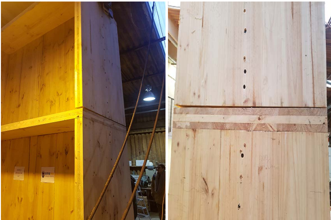
Figura C 4: Tornillos Largos sin Daños de Extracción en Ensayo N°1 (Izquierda) y Ensayo N°2 (Derecha).
