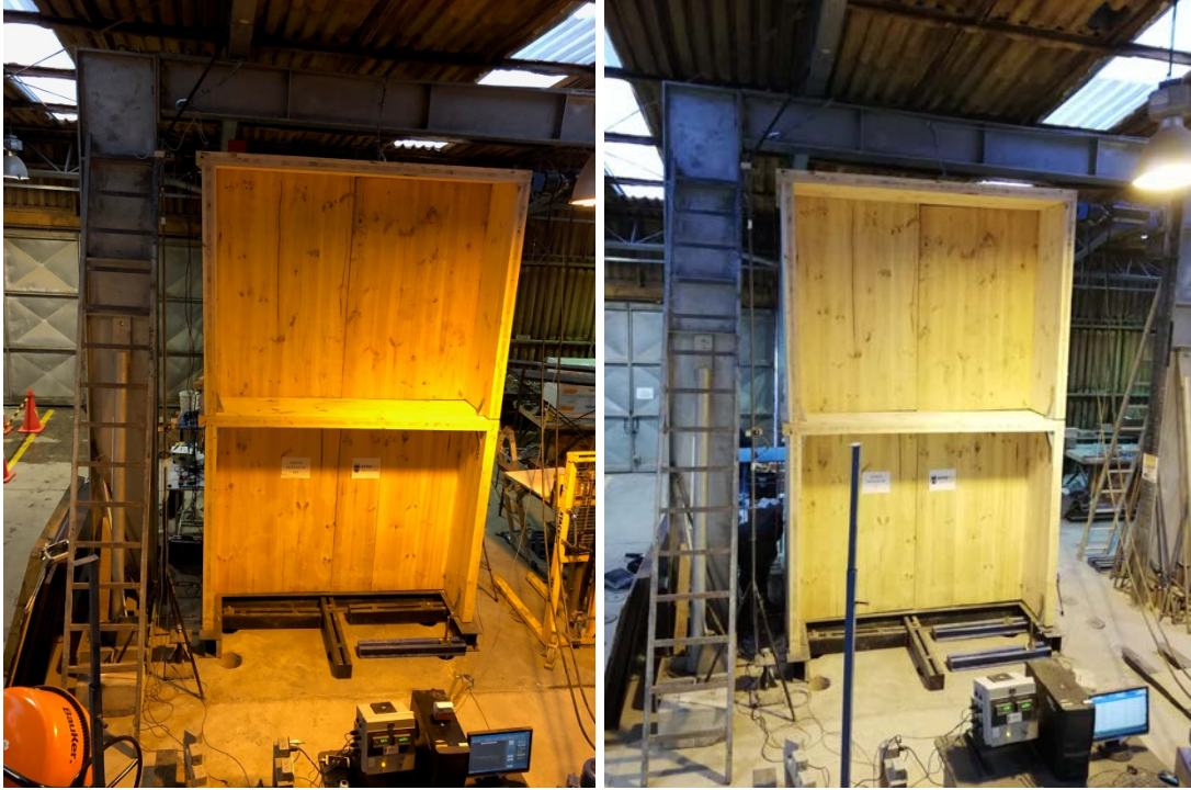
Figura C1: Estado Ultimo Probeta Ensayo N°1 (Izquierda) y Ensayo N°2 (Derecha).
