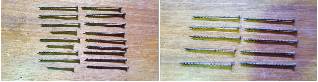
Figura C9: Tornillo DSVT3R al final del Ensayo N°1 para el Nivel 1 (Izquierda) y Nivel 2 (Derecha).
