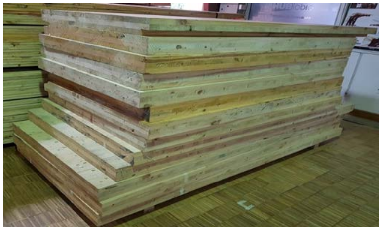
Figura 15: Paneles de CLT (Elaboración Propia, 2019).
