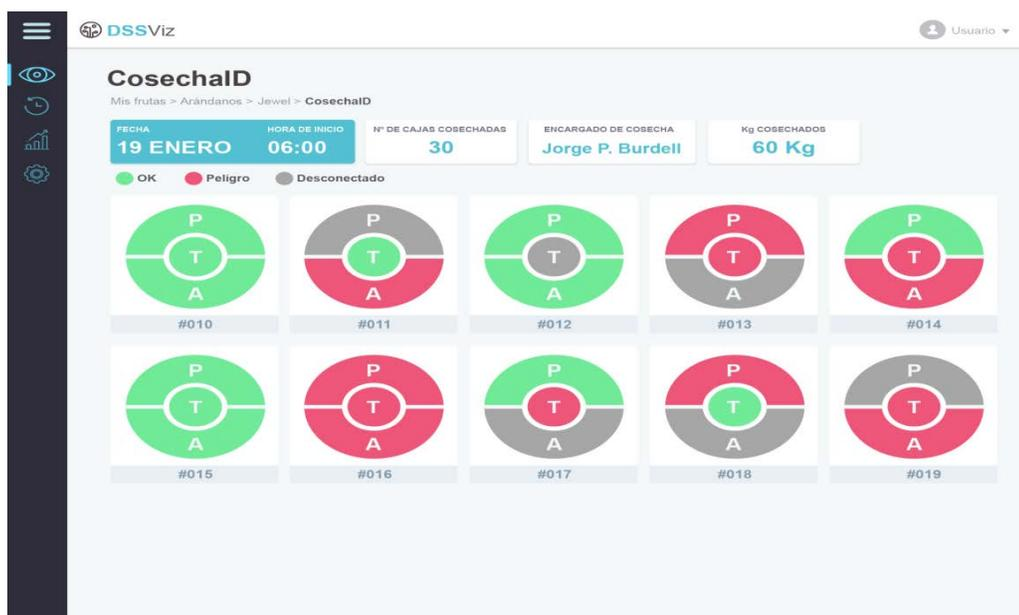
**Figura 1.3:** Maqueta de visualización de estado (Peso, Temperatura y Aceleración) de nodos en tiempo real.
