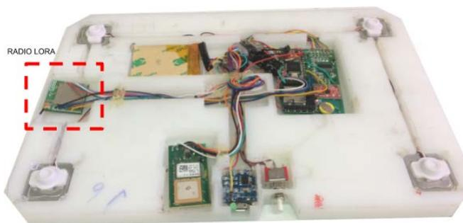
**Figura 1.2:** Montaje de dispositivos en la base de caja cosechera.
