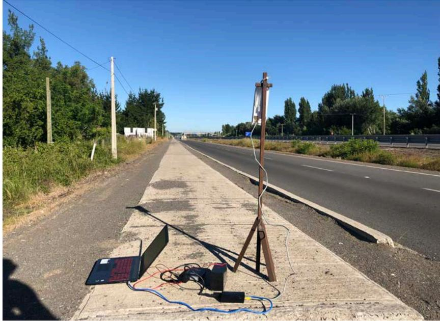
**Figura 5.18:** Montaje de CPE510 aplicación cliente.
