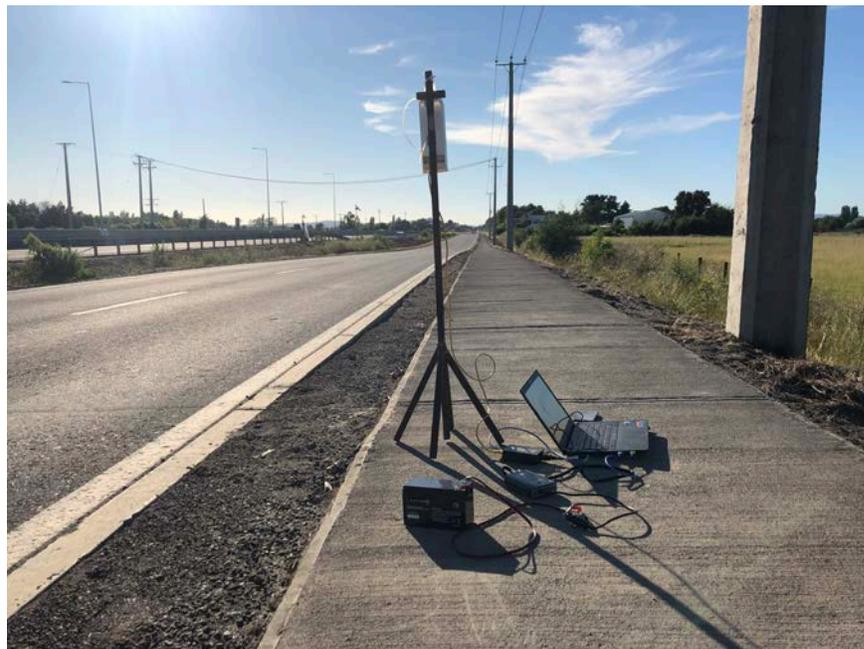
**Figura 5.19:** Montaje de CPE510 aplicación servidor.
