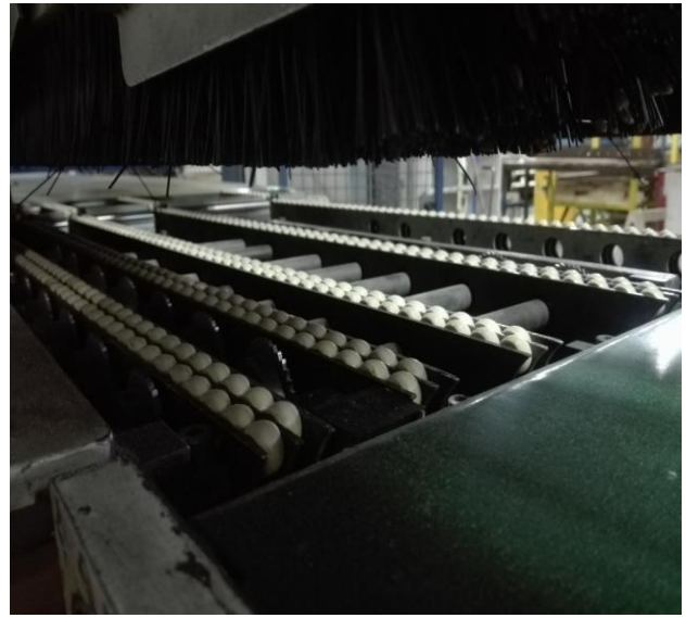
Figura N°3.2: Discos dentados y ruedas.
