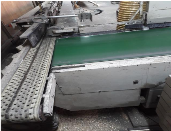
Figura N°3.8: Cinta perforada y cadenilla
