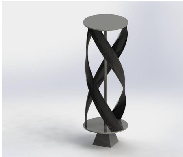
Figura 2.12: Ilustración Turbina Helicoidal Gorlov. Fuente: GRAB CAD COMMUNITY.
