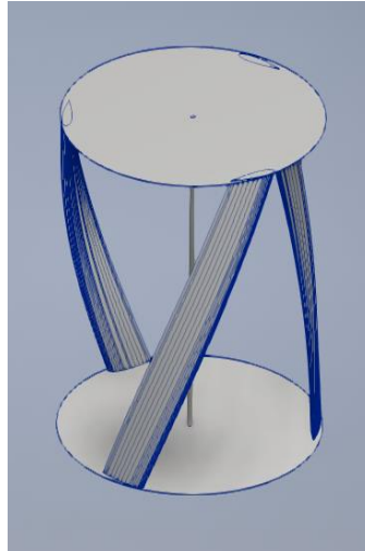
Figura 3.2: Segundo Prototipo Turbina GHT. Autor: Mónica Zamora Zapata.
