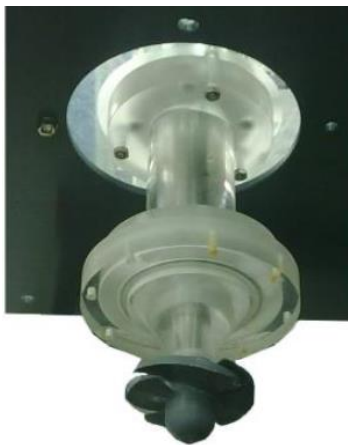
Figura 2.2 "Turbina Kaplan con eje principal"
