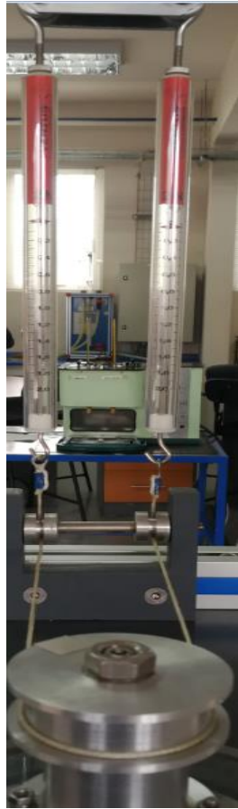
Figura 2.5 “Dinamómetros conectados a la polea”
