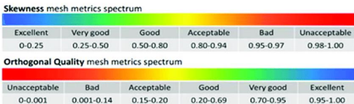
Figura 4.10 “Escala de Asimetría para la determinación de la calidad de la malla”
