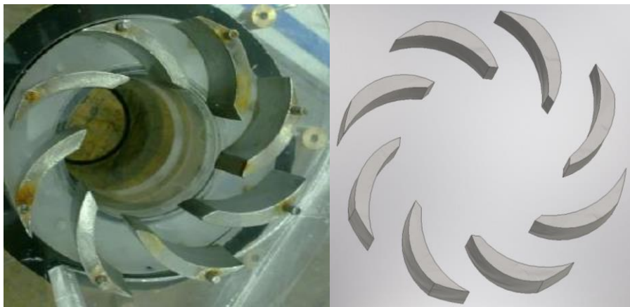
Figura 4.5 "Comparación Distribuidor real con el dimensionado en Inventor Autodesk"
