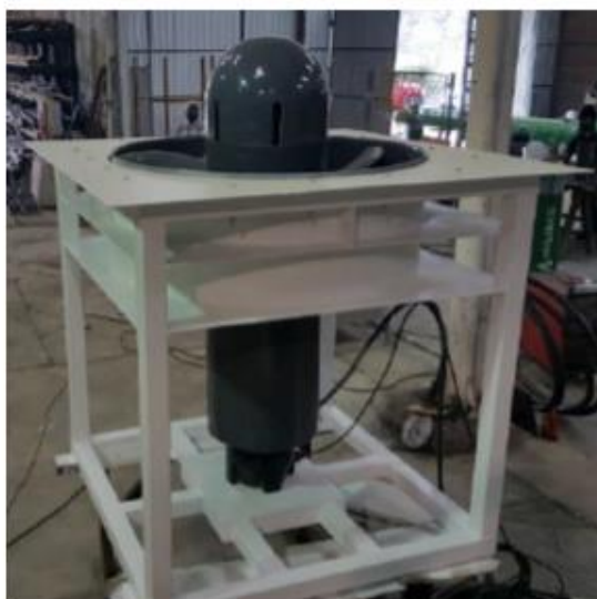
Foto de turbina Kaplan de 15 KW
