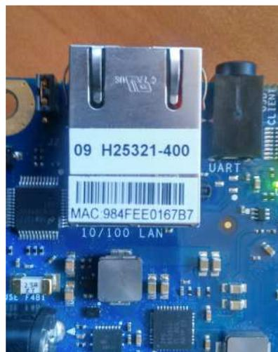
Figura 43: Identificación dirección MAC Intel Galileo
