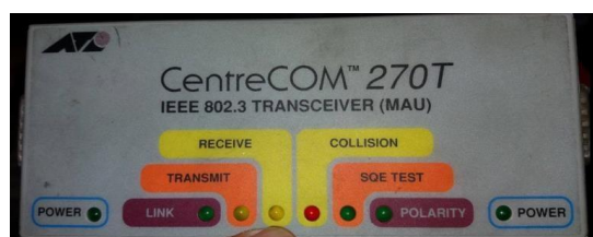
Ilustración 41. Transceptor CentreCOM 270 T.
