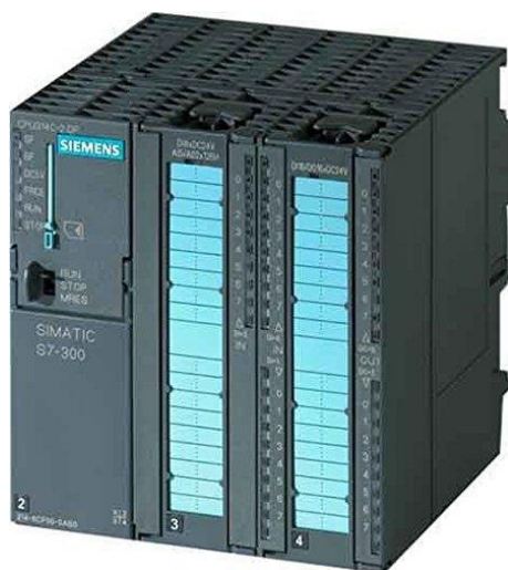
Ilustración 36. Controlador lógico programable S7-300.
