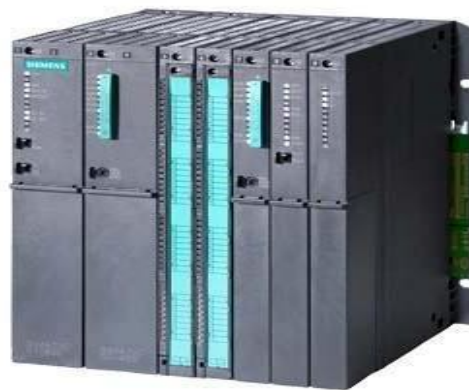
Ilustración 37. Controlador lógico programable S7-400.
