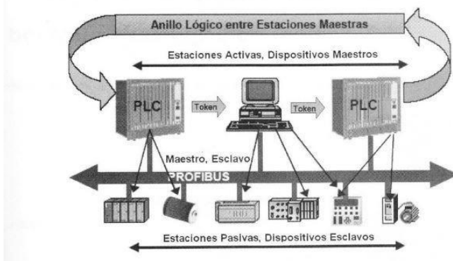
Ilustración 30. Equipos participantes en una red Profibus.
