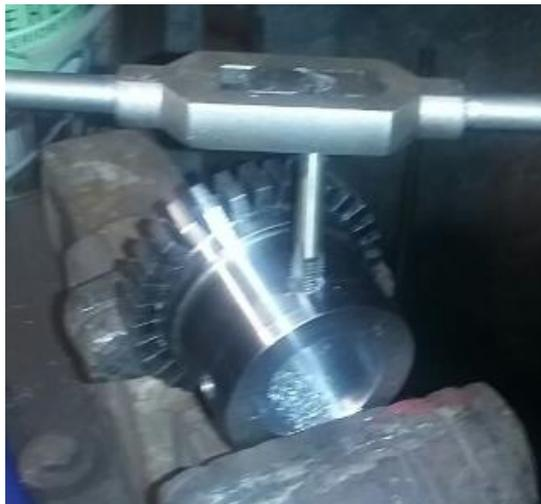
**Figura N°63** “Adaptación acople 1050T según motor”
