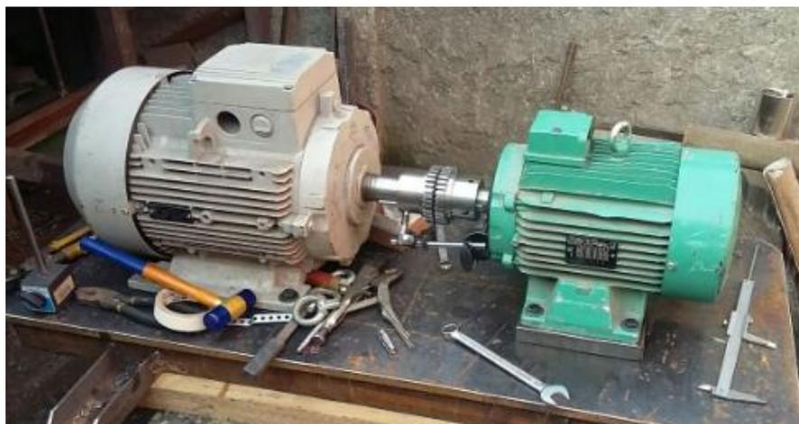
**Figura N°64** “Alineación de motores con los acople”
